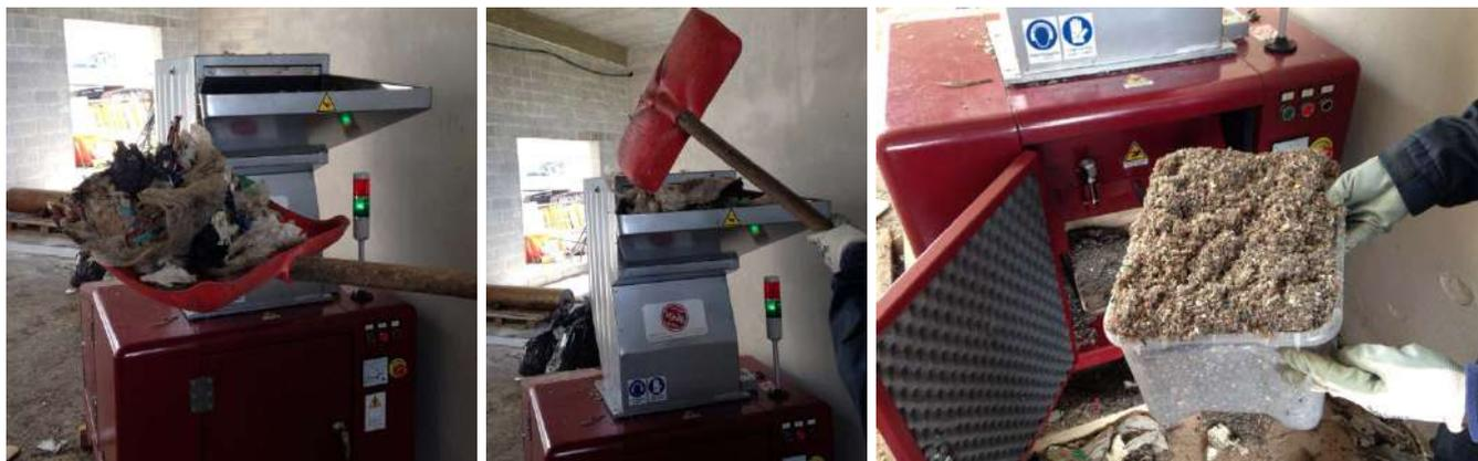
**Figura 6:** Mulino per la riduzione del campione e relativo materiale in uscita
