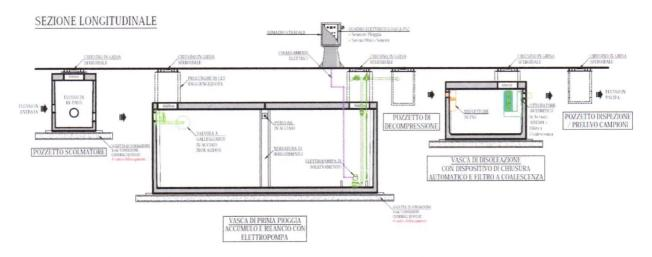
Di seguito si riporta lo schema planimetrico del sistema di depurazione con Pozzeto Fiscale di controllo.
