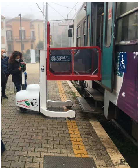
Fig. 12: sollevamento del cesto fino alla quota del pianale del treno
