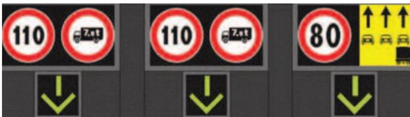
Figura 3-5 Esempio di pannelli variabili di segnalazione per il controllo dinamico della velocità
