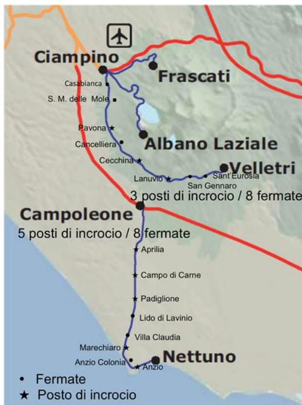
Figura 4-1 Punti di incrocio sulle linee Campoleone-Nettuno e Ciampino-Velletri
